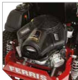
Silnik Briggs & Stratton Commercial Series posiada pięciostopniowy system filtracji pyłów i cząstek z wbudowanym cyklonicznym filtrem powietrza.
