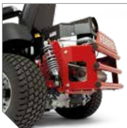
Tylne zawieszenie ze sprężynami i wahliwa oś przednia z amortyzatorami tłumiącymi drgania.
